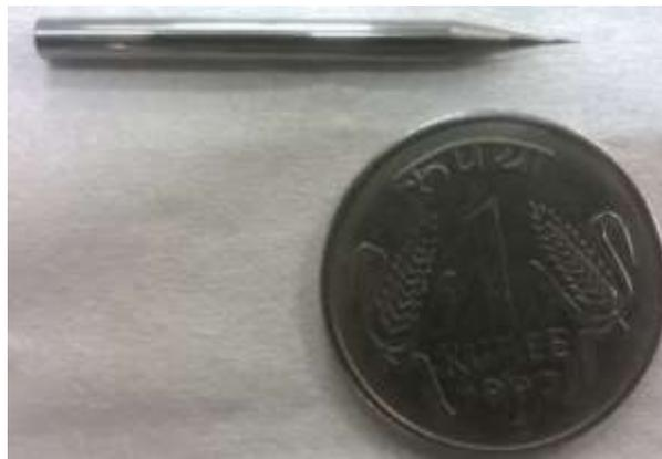
**Figure 4.19** End Mill ( $\varnothing 0.2$  mm) for Micromilling
